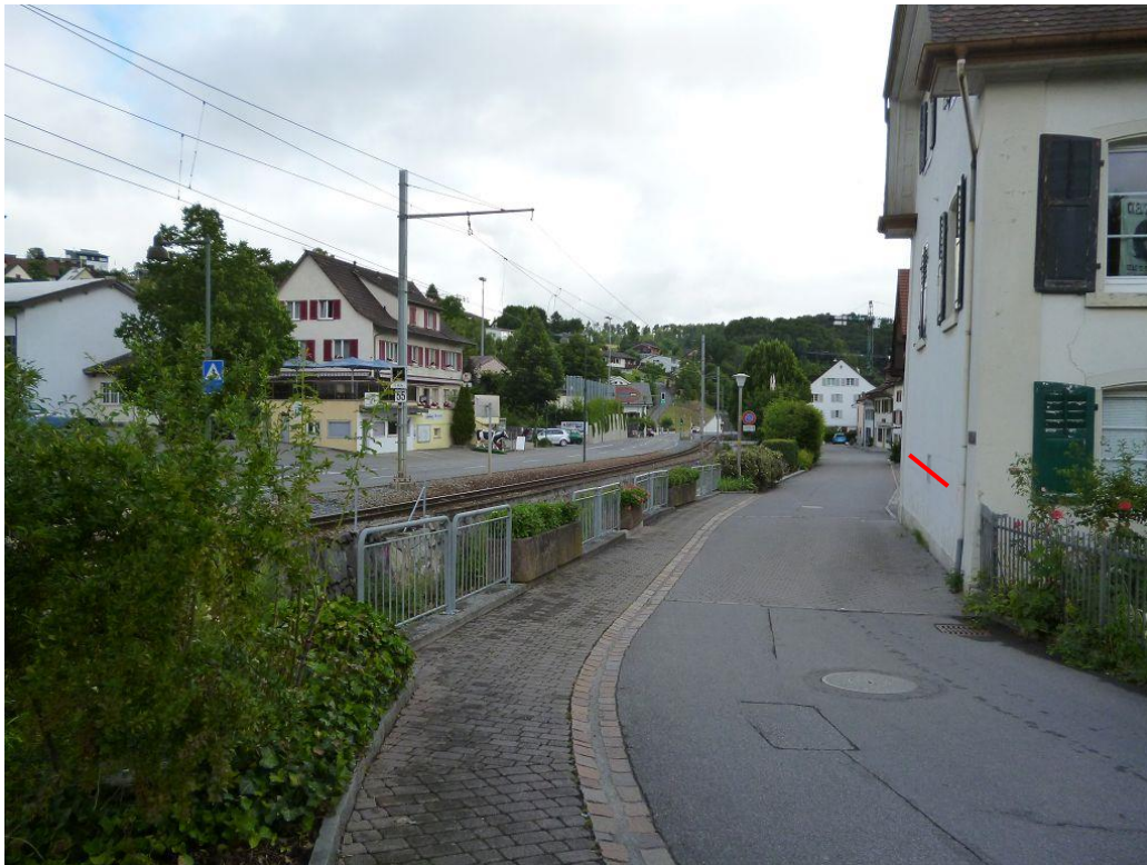
km 10.900: Engstelle Dorfstrasse 40. An der Hauswand in eine Hochwassermarke vom Hochwasser 16.7.1830 erkennbar und rot gekennzeichnet (Abfluss gem. Grundlage [17] 60-100 m 3 /s). Blick in Fließrichtung
