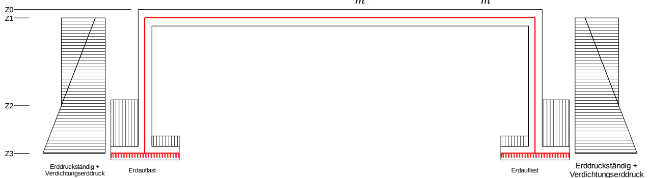
Abbildung 5 Erddruck infolge Bodeneigenlast
